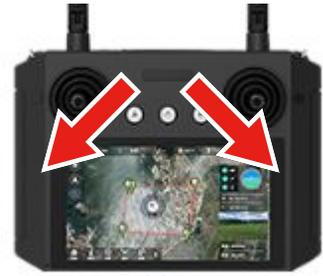
기체 모터 정지 방법은 2가지가 있습니다. 착륙 후 스로틀 스틱을 최하단으로 위치하고 3초간 대기하면 모터 구동이 정지하며, 기체가 정지합니다. 시동을 걸고 즉시 정지를 희망하는 경우에는 스로틀 스틱을 (방법2) 처럼 바깥으로 내려주고 잠시 대기하면 모터 회전이 정지합니다.
